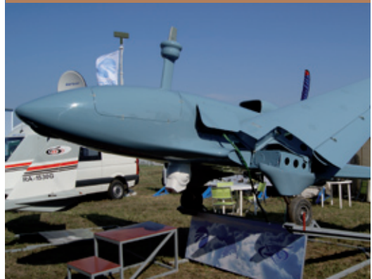
FOT. 2. BEZAŁOGOWY STATEK POWIETRZNY ŁUCZ, uwagę zwraca nietypowy sposób składania skrzydła
