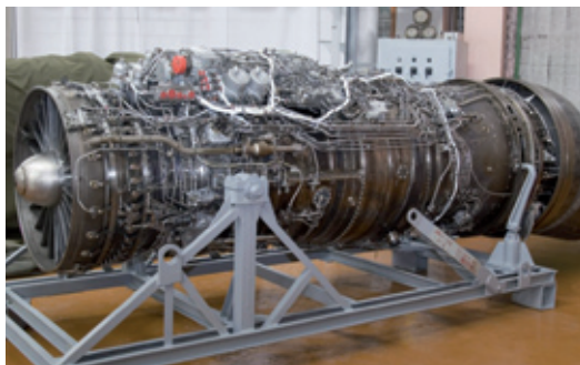
FOT. 1. SILNIK AL-41F1A , w kodzie produkcyjnym Izdlielje 117S (w oryginale 117C). Agregaty silnika wraz z przekładnią są umieszczone w części grzbietowej silnika
